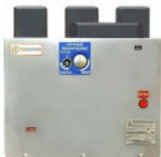
Вакуумный выключатель ВБСК-Р-10 со встроенным электромагнитным приводом предназначен для коммутации электрических цепей при нормальных и аварийных режимах в сетях трехфазного переменного тока с изолированной нейтралью частоты 50 Гц с номинальным напряжением 10 кВ. Выключатель ВБСК-Р-10 устанавливается в шкафах комплектных распределительных устройств (КРУ и КСО), а также используется для замены маломасляных и электромагнитных выключателей. Вакуумные выключатели ВБСК-Р-10 ,
