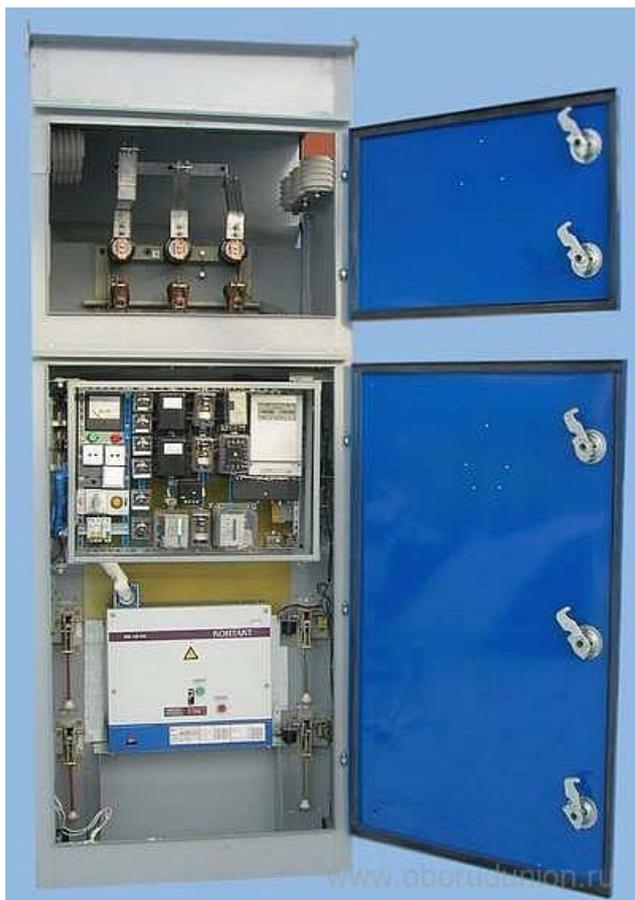
Ячейка КРН-IV-10 применяется для приема и распределения электрической энергии трехфазного переменного тока частотой 50 Гц напряжением 6 и 10 кВ и используется в распределительных устройствах собственных нужд электростанций, электрических подстанций энергосистем и промышленных предприятий, а также на объектах энергоснабжения ответственных потребителей сельского хозяйства.
